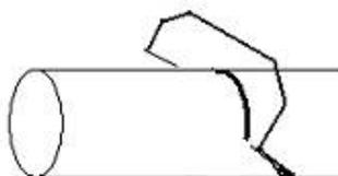
Corte e fure ao centro para passar um parafuso de aço de  $\varnothing$  3 mm.
